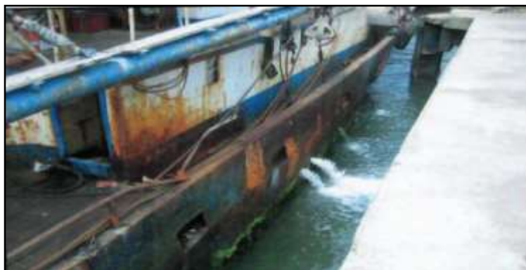
Photo 2 : Un navire en situation de déballastage à quai au port commercial de Port-Gentil
