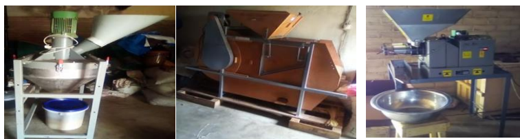
Photo 6: Une machine multifonctionnelle pour décortiquer, vannage et l'extraction de l'huile
